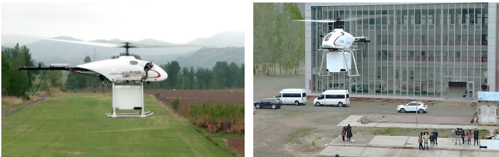
图 46 飞行作业中的机载偏振激光雷达
