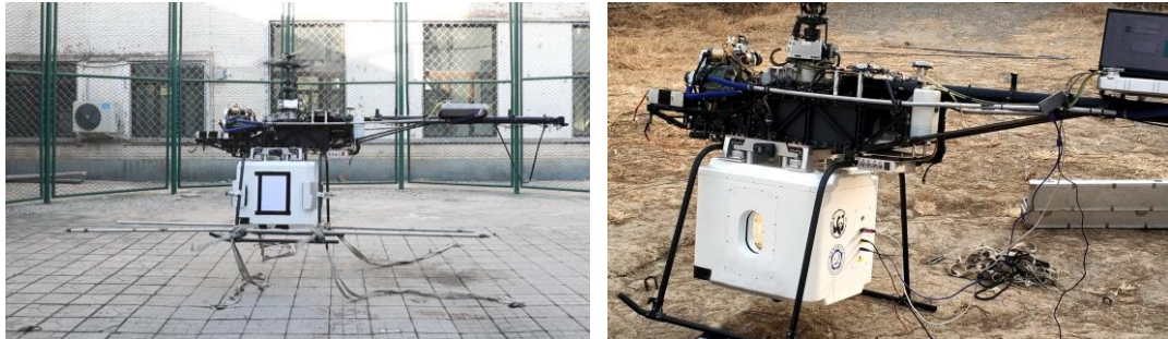
图 41 无人直升机载偏振激光雷达场地系留测试和振动测试照片
