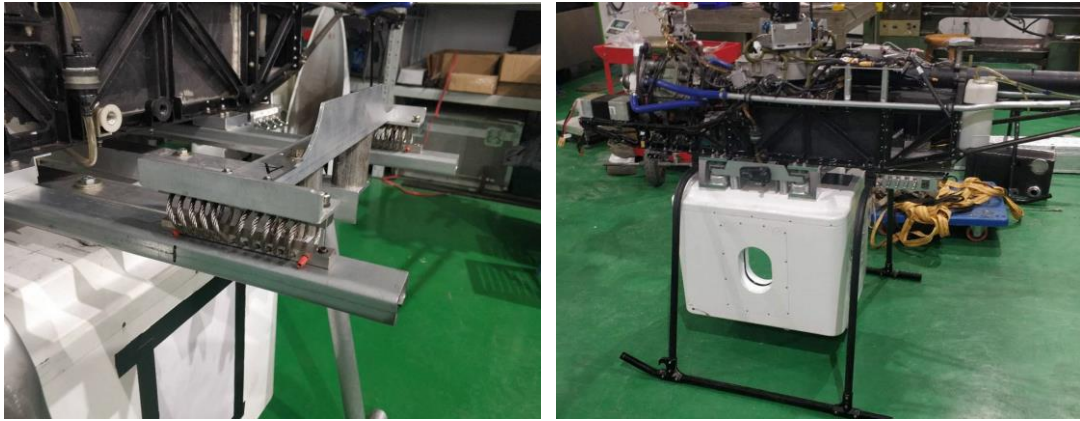
图 40 一级和二级减震悬挂方案照片
