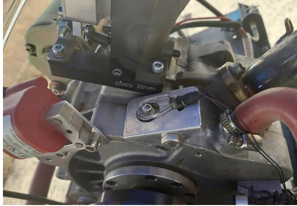
图 39 无人直升机汪克尔转子发动机照片
