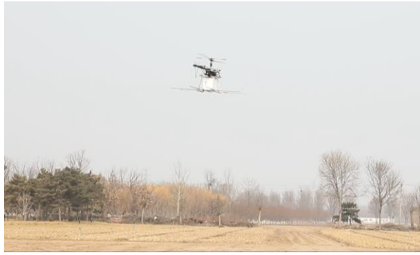
图 42 无人直升机在偏振激光雷达外场放飞稳定性测试照片
